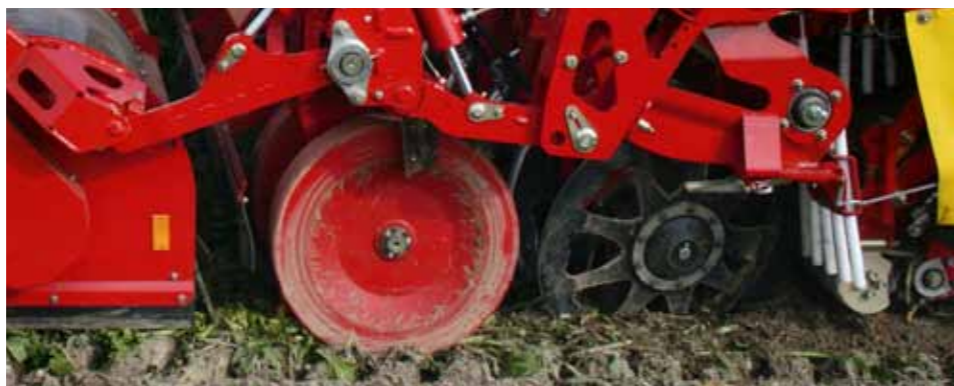
Wychylne w bok (40 mm) i napędzane hydraulicznie wyorywacze kołowe optymalnie wykopują buraki również na nierównych rzędach
