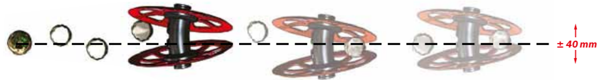
Wychylne w bok (40 mm) i napędzane hydraulicznie wyorywacze kołowe optymalnie wykopują buraki również na nierównych rzędach
