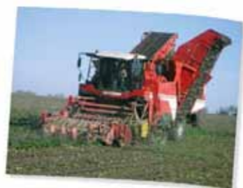
Zachwaszczone pole w Rosji: bez problemu dla rozdrabnicza liści z bocznym prznośnikiem odprowadzającym i obrotowym dogławiaczem
