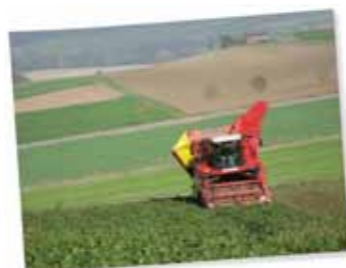
Na wzgórzach w Szwajcarii układ poziomujący utrzymuje MAXTRON'a 620 we właściwej pozycji
