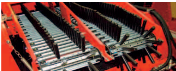
Typ UB: najlepsza skuteczność oddzielania na glebach z tendencją do zbrylania się, zawierających niewielką ilość kamieni
