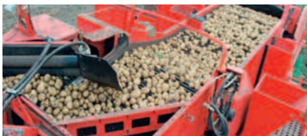
Typ NB: najlepsza skuteczność oddzielania na glebach z małą zawartością kamieni i brył
