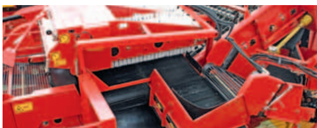
Typ SB: najlepsza skuteczność oddzielania na glebach kamienistych dzięki innowacyjnemu, kinematycznemu separatorowi kamieni
