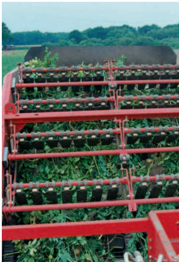
Optymalna ochrona bulw: taśma łączinowa z miękkimi poliuretanowymi łopatkami (odstępny do wyboru 200 mm, 280 mm)
